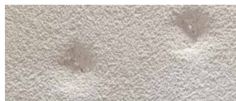
ETICS se zvýšenou mechanickou odolností 125 J
